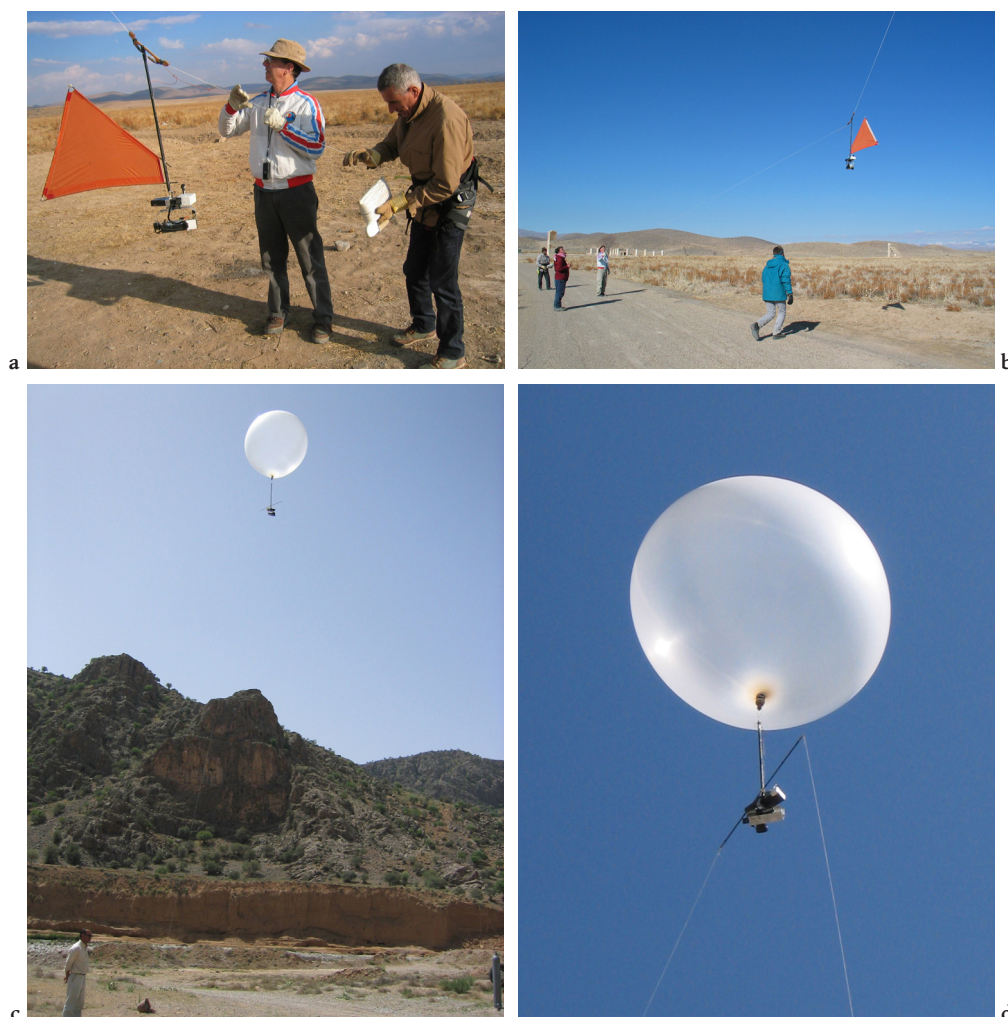
Fig. 3 : Technique de prises de vues aériennes sous cerf-volant (a, b) ou ballon captif (c, d) a. Accrochage de la nacelle sur le fil du cerf-volant en vol. Outre l'appareil photographique, celle-ci emporte aussi un anémomètre, une mini-caméra et un GPS. L'appareil est monté sur une structure orientable et téléguidable depuis le sol; un moniteur permet de contrôler le cadrage et l'orientation du dispositif pour prendre des vues verticales ou obliques. b. Envol de la nacelle jusqu'à l'altitude choisie pour la prise de vues. c. La technique du ballon captif permet de réaliser des vues aériennes dans des secteurs où le relief rend difficile l'emploi du cerf-volant (ici dans les gorges du Tang-e Bolaghi à côté de Pasargades) ou lorsqu'il n'y a pas de vent. d. Vue rapprochée du ballon; le dispositif de la nacelle est comparable à celui utilisé en cerf-volant; deux câbles maintiennent le ballon à une altitude fixe et le stabilisent.
