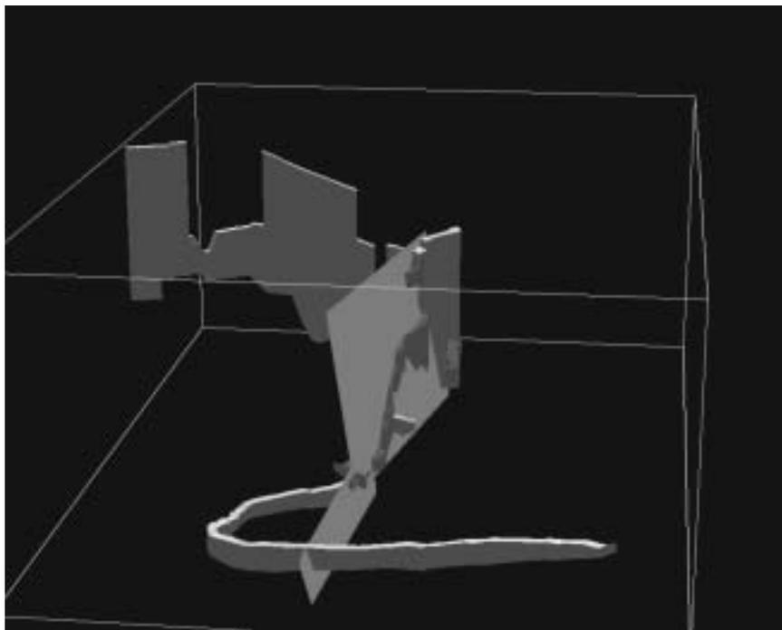
fig. 27 : vue en trois dimensions de la partie explorée de la *qanāt* « MQ13 ». En clair, plan de faille. En foncé, section drainante des galeries à l'époque romaine. Logiciels utilisés, voir fig. 16. Cf. <http://www.thotm-editions.com/qanats/wuttmann/figure27.htm>.
