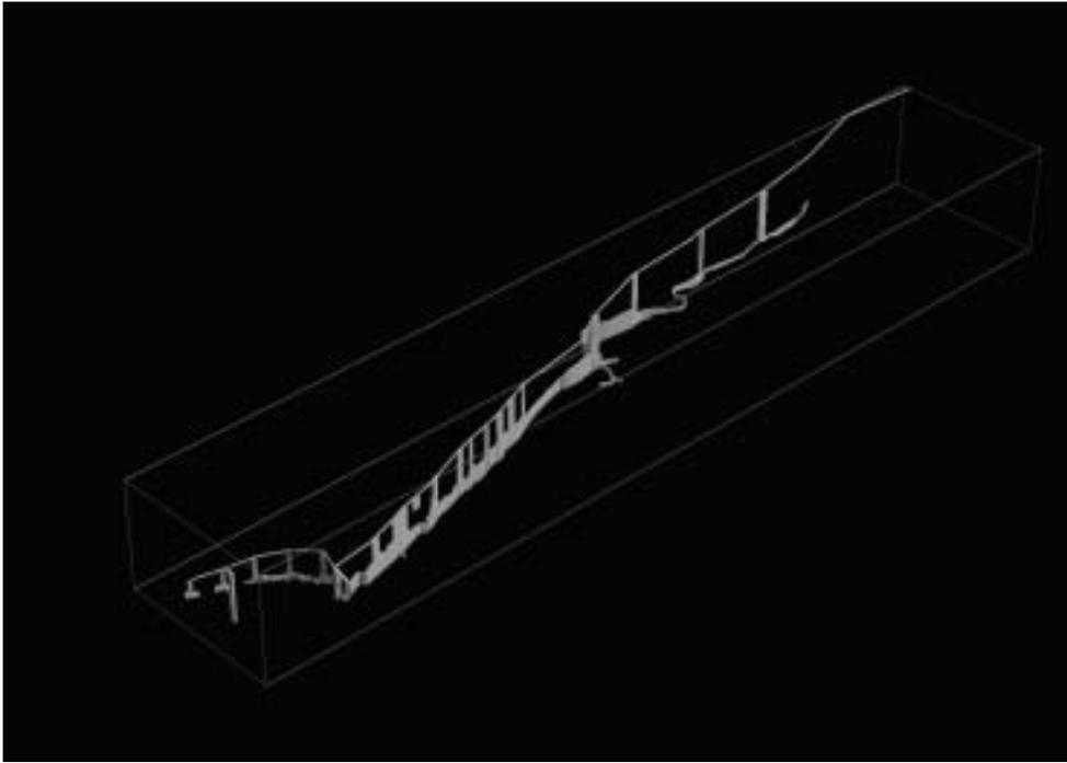
**fig. 16 :** vue en trois dimensions de la galerie de la *qanāt* «MQ4». Réalisée grâce aux logiciels Limelight (saisie des données, par Martin Heller, <http://www.geo.unizh.ch/~heller/toporobot/>) et Geo3D (visualisation 3D, par Stefan Huber, <http://www.topoi.ch>). Cf. <http://www.thotm-editions.com/qanats/wuttmann/figure16.htm>.
