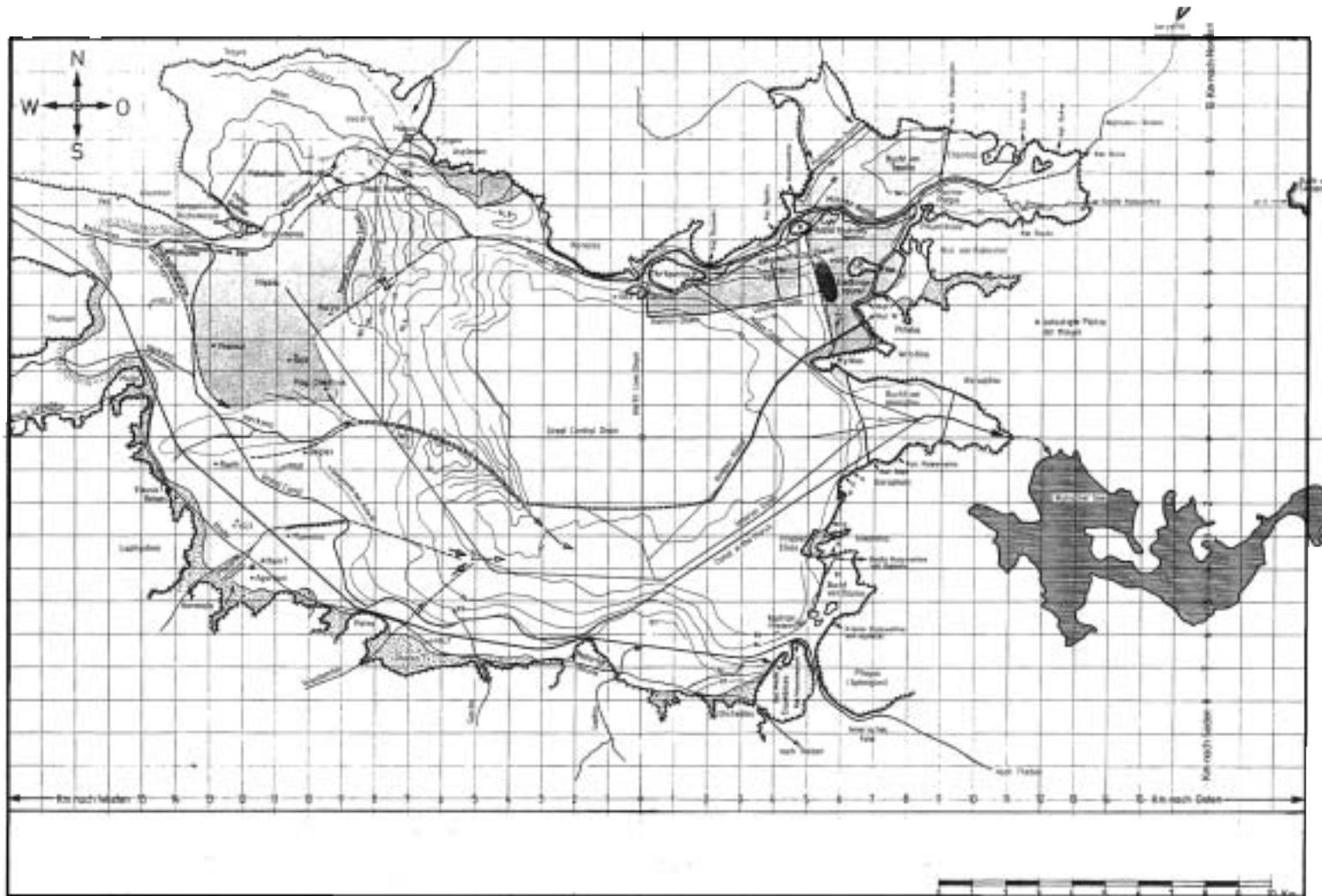
fig. 2a: lac Copais, plan du système de drainage avec les principales installations antiques, d'après Knauss 1984, carte 1.
