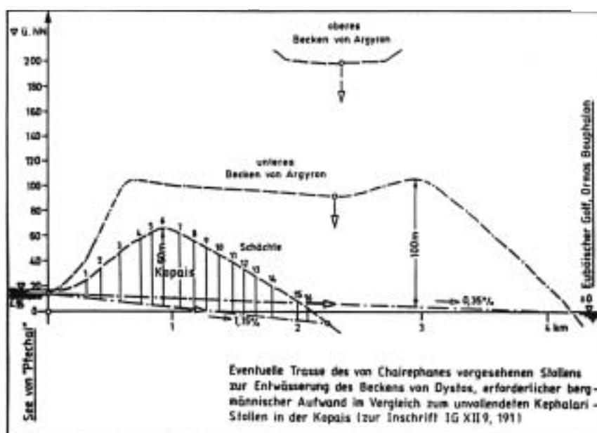
fig. 4 : coupe montrant la galerie percée sous le col de Képhalari (Copaïs) en comparaison avec celle qu'impliquerait l'identification du lac de Ptéchai au lac de Dystos (d'après J. Knauss, *Wasserbau und Geschichte*, p. 262, fig. E5)
